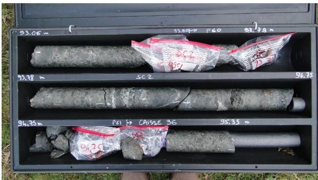
**Figure 25 : Exemple d'une caisse avec carottes (forage SC2).**
